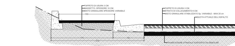
Sezione tipo progetto Guard Rail - Scala 1:20
