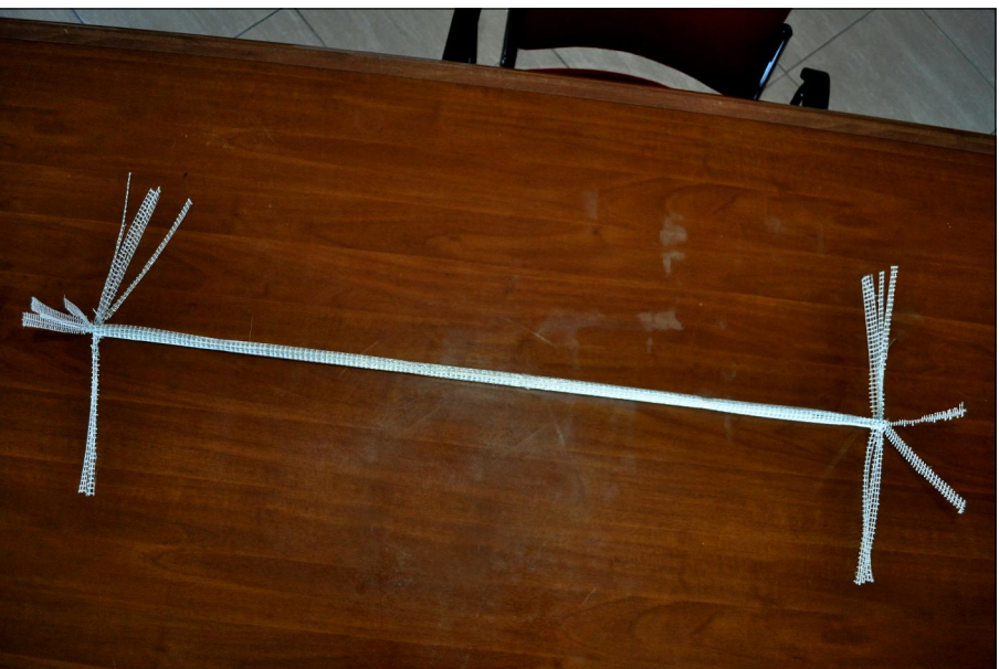
P2 Fiocco in fibra di acciaio tipo Fidsteel tube 3x2 G4
