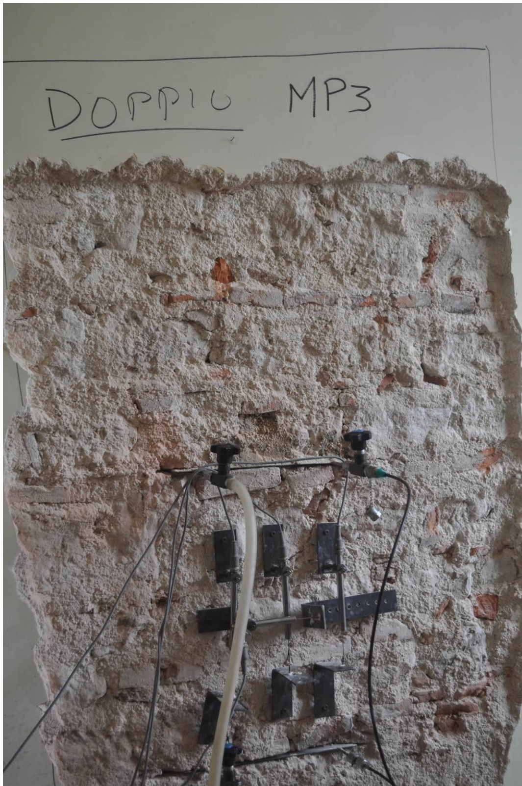
ubicazione della prova con disposizione della strumentazione e particolare dell'elemento murario provato.
