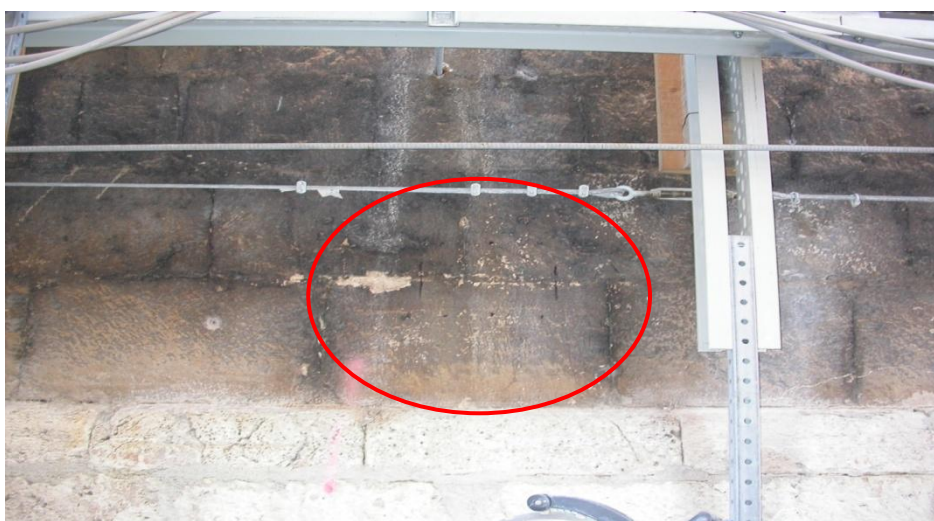
Figura 6: Martinetto Piatto Singolo: particolare dell'elemento murario provato
