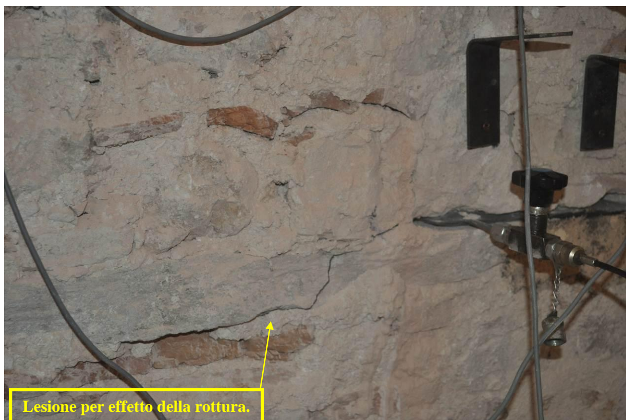
rilievo delle lesioni al termine della prova sulla muratura .
