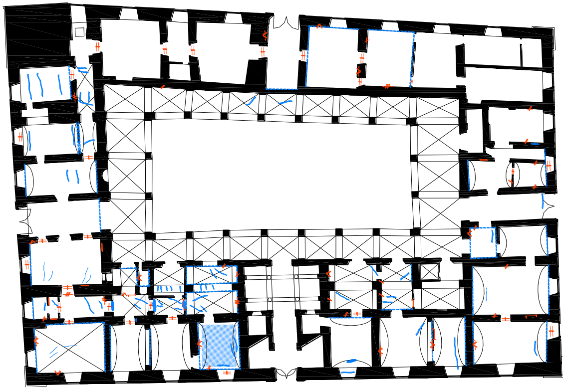
Figura 1: pianta del primo livello del fabbricato con individuazione delle unità strutturali
