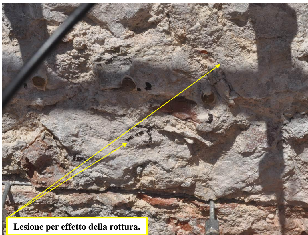
rilievo delle lesioni al termine della prova sulla muratura .
