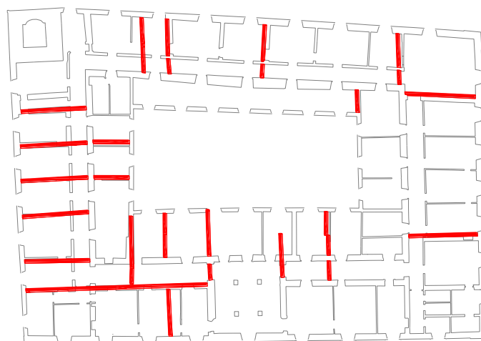
Figura 17: Piano Secondo – schema di inserimento di nuovi elementi resistenti
