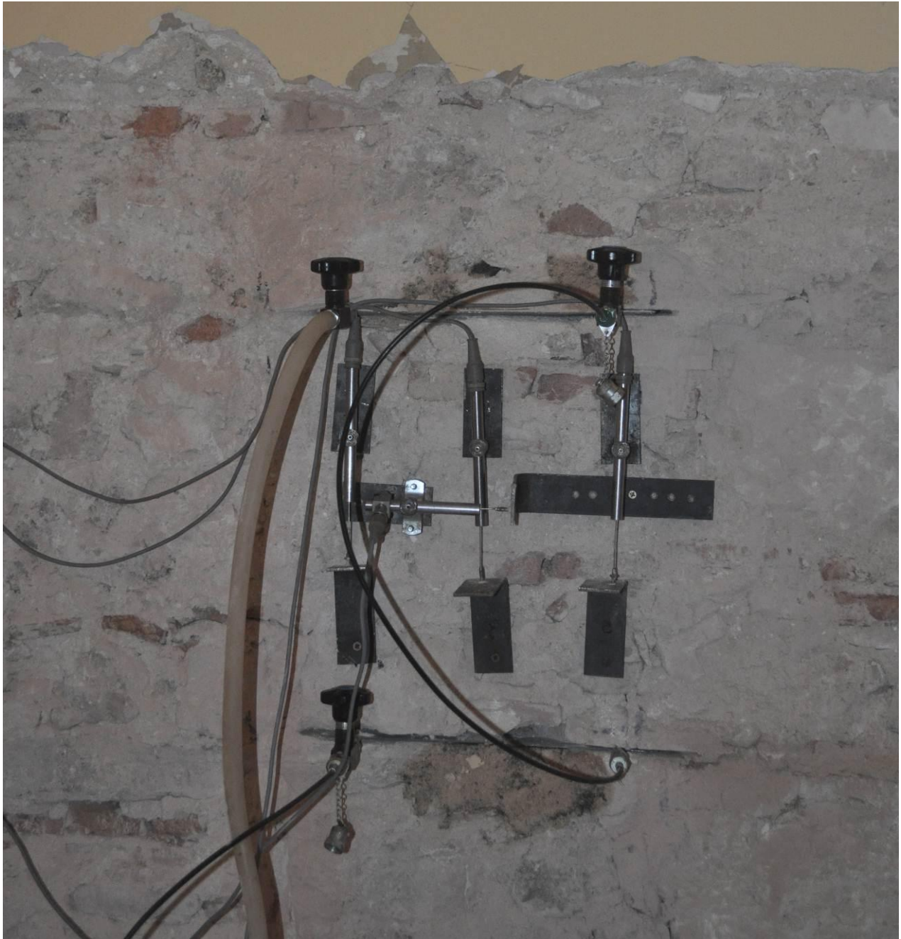
ubicazione della prova con disposizione della strumentazione e particolare dell'elemento murario provato.
