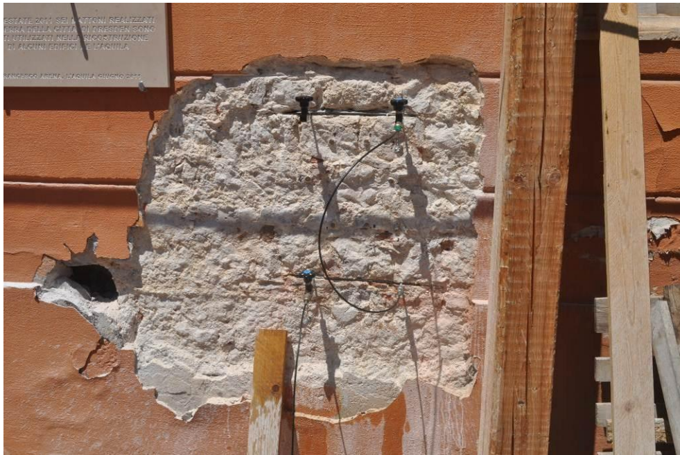
ubicazione della prova con disposizione della strumentazione.
