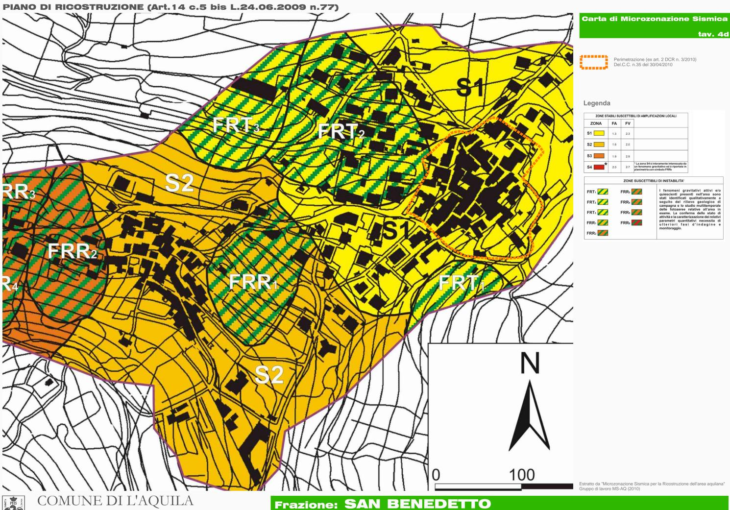
Estratto da "Microzonazione Sismica per la Ricostruzione dell'area aquilana" Gruppo di lavoro MS-AQ (2010)
