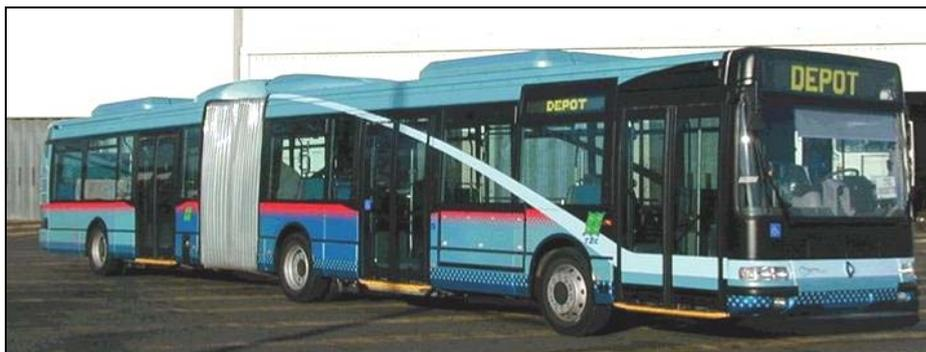
Figura 61 Irisbus Agora L (autoarticolato) a Clermont-Ferrand dotato di sistema a guida ottica
