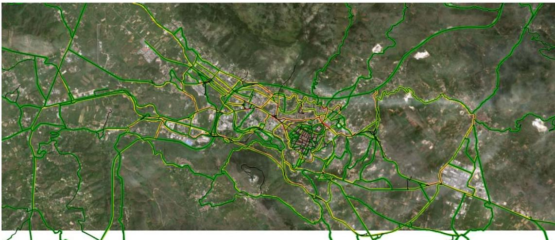
Figura 222. Sottorete città multipolare: scenario Progetto PUM+ADD - grado di saturazione fascia oraria 8:00-9:00.
