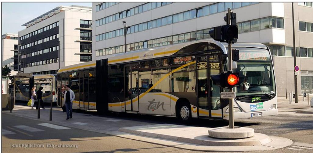
Figura 51 Priorità alle intersezioni lungo le linee BHLS (Nantes)
