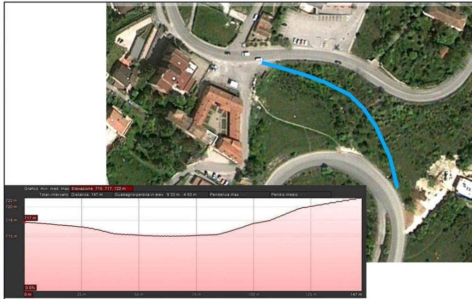
Figura 124 Profilo altimetrico del raccordo di progetto
