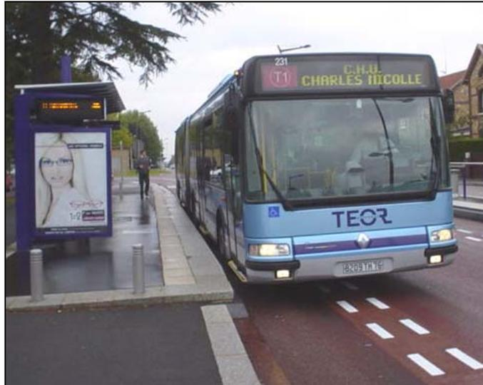
Figura 62 Linea Teor a Rouen: mezzo tradizionale dotato di sistema a guida ottica.
