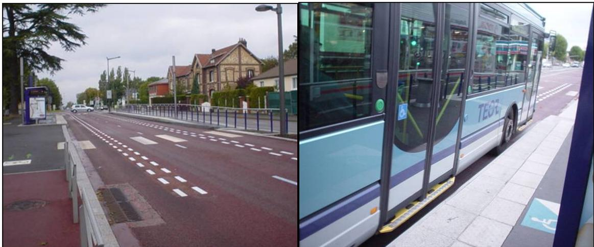
Figura 63 Rouen: Linea Teor utilizzazione della guida ottica per l'accostamento alle fermate.
