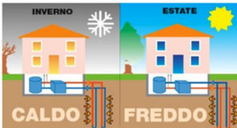
Figura 3 – Funzionamento della pompa di calore in inverno e in estate
