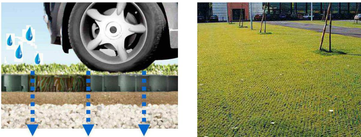
Figura 12.6: Area di parcheggio realizzata con il sistema del "prato armato".
