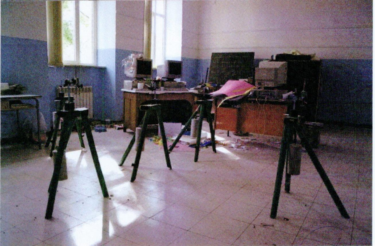
Prova di carico Solaio
