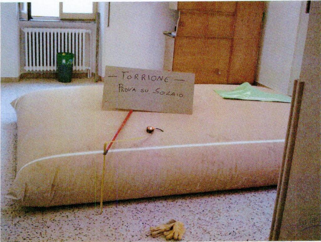
Prova di carico Solaio
