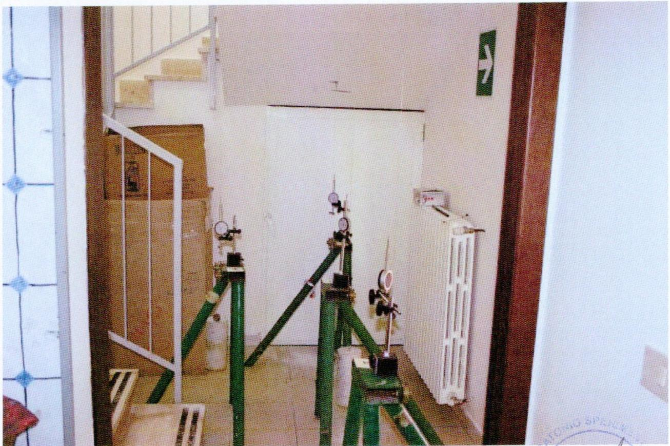
Prova di carico Scala
