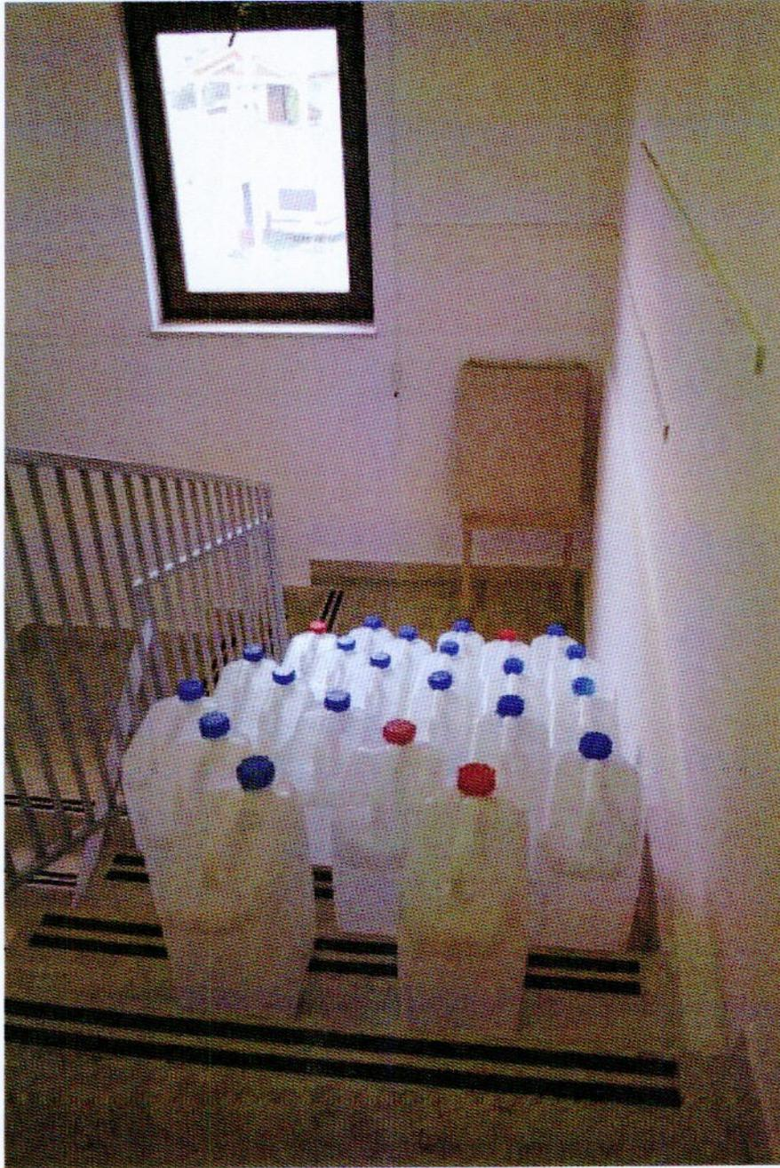
Prova di carico Scala
